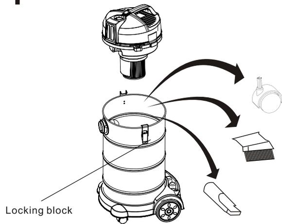
Suelte el bloque de bloqueo para abrir la carcasa, saque las ruedas y los accesorios.
