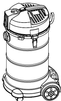
Vuelva a colocar la carcasa superior y fije el bloque de bloqueo.
