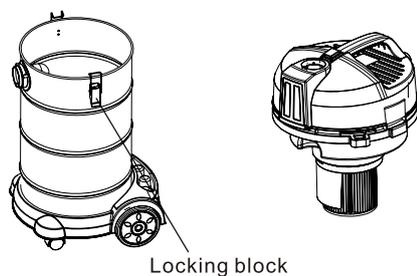
Suelte el bloque de bloqueo para abrir la carcasa superior.
