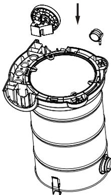
1. Instale las ruedas giratorias en el orificio de la base.
