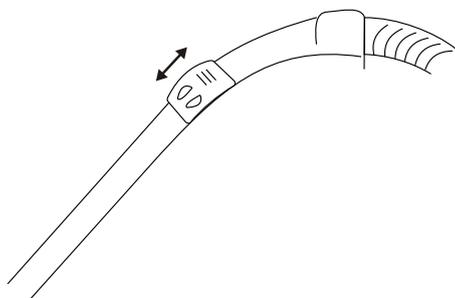
Puede ajustar el flujo de aire empujando el bloque deslizante hacia arriba y hacia abajo.
