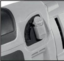
• Esta herramienta se puede operar con un corte orbital o una acción de corte en línea recta. La acción de corte orbital empuja la hoja hacia adelante en la carrera de corte y aumenta considerablemente la velocidad de corte
