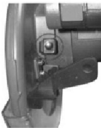
Para cambiar la hoja de sierra, el eje de transmisión debe bloquearse en su lugar con el bloqueo del eje. El botón está ubicado justo encima de la palanca de seguridad (5) en el motor. Ahora afloje el tornillo de montaje de la hoja de sierra con la llave de anillo incluida. Para aflojar el tornillo, gire en la dirección de rotación de la hoja de sierra. Una vez que se hayan quitado el tornillo y la brida exterior, se puede quitar la balde de la sierra.
