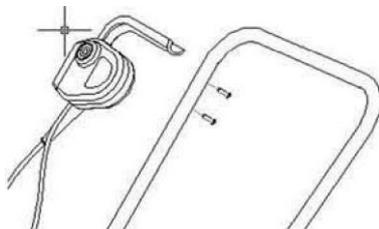
Abra las dos partes móviles del bloque de interruptores de par en par e inserte los pasadores en los orificios de la manija superior. Presione ambas partes con fuerza para que los pasadores se inserten completamente en los agujeros. Apriete con los últimos 2 tornillos grandes (32 mm) provistos. Saque las abrazaderas para cables de la bolsa y fíjelas a las dos manijas para que el cable quede asegurado contra la manija durante la operación.
